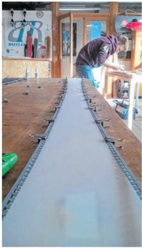
**2** Echte Randarbeit: Jetzt müssen die Kanten mit Sekundenkleber und Klammerchen an den vorbereiteten Laufflächen befestigt und an den Schaufeln und Skienden leicht gebogen werden.
