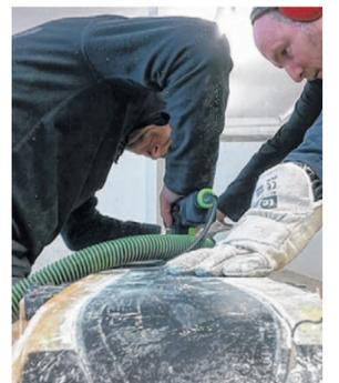
**9** Aufschneider: Mit einer Stichsäge befreit man die Ski aus dem Holz-Glasfaser-Klumpen. Ein „Build 2 Ride“-Profi macht den Grob-, jeder Teilnehmer den Feinschliff. Die Deckkante wird entgratet, das Furnier poliert.
