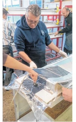
**6** Das Packen vor dem Backen: Ein großer Plastiksack kommt über das Paket. Dieser wird vakuumiert. Durch den Unterdruck passt sich der Ski der Laminierform an.
